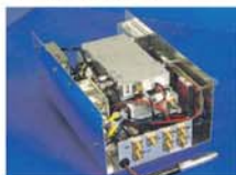
Prototipo de radar de apertura sintética (SAR) embarcable en aparato de vuelo no tripulado (UAV) desarrollado en RSLAB.
