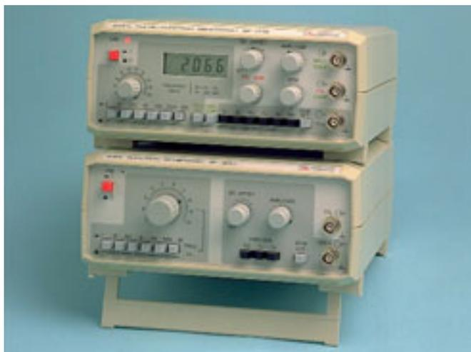
El **GF-230** es un generador de funciones que cubre el margen de frecuencias de 0,1 Hz hasta 1 MHz en siete décadas. Permite generar ondas cuadradas, senoidales y triangulares con control continuo del nivel de salida, atenuador fijo de 20 dB y posibilidad de sobreponer un nivel de continua por medio del control de OFFSET. Una entrada exterior VCO permite controlar la frecuencia de salida y modular en FM mediante cualquier señal auxiliar.
